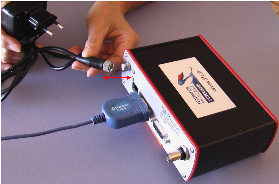
Connexion de l'alimentation électrique.
